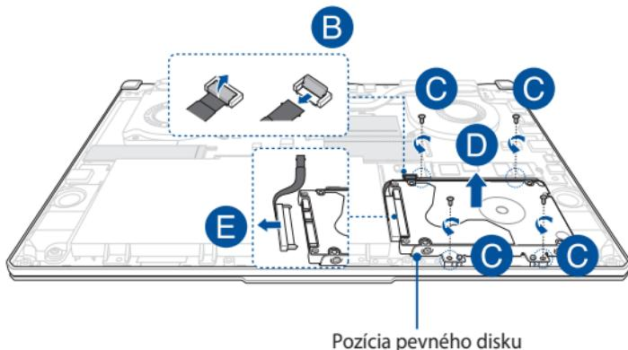
F. (Voliteľné) Ak je pevný disk aktuálne pripojený k pozícii pevného disku, pozrite si nasledujúci postup na vybratie starého pevného disku:
